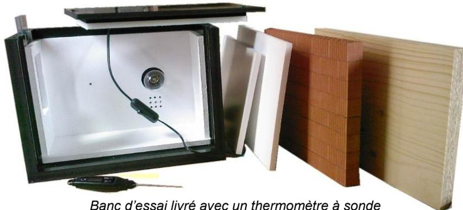
*Banc d'essai livré avec un thermomètre à sonde*
