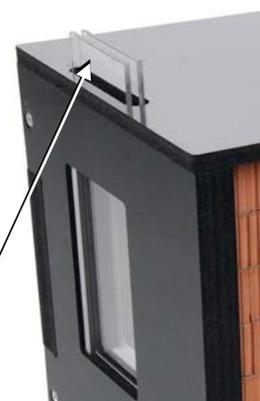
Une fenêtre double vitrage, placée sur un mur de côté, permet des investigations supplémentaires.
